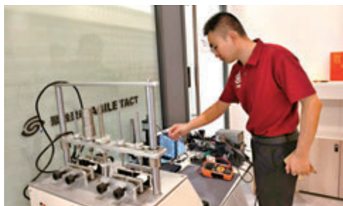
●郭棟正在調試機器，測試三維力傳感器。
