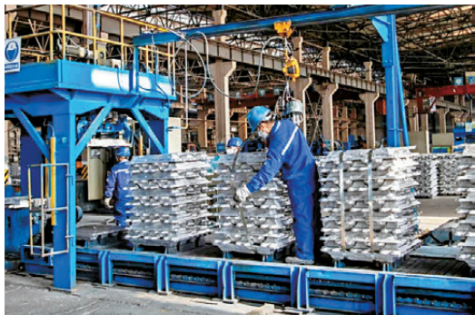
●在陝西有色榆林新材料集團鑄造車間，工人師傅正忙着對生產線上的鋁錠打網。網上圖片
