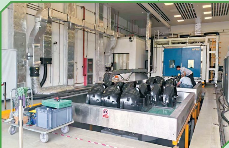
▲工作人員在燃料電池系統性能振動環境三合一綜合實驗室內進行振動衝擊實驗。
