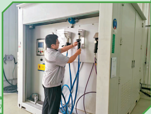
▲工作人員在燃料電池系統性能振動環境三合一綜合實驗室內進行振動衝擊實驗。
