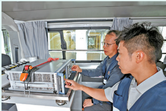
●外勤干擾調查組配備專用車輛，運用定位測向技術實地追查故障或違規發射器。
