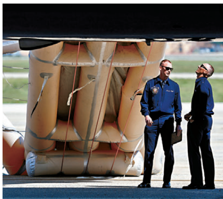
●機組人員檢查逃生滑梯。
