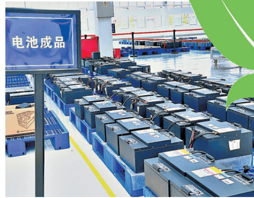
●經過測試重組後的「退役」電池包整齊碼放在藍色托盤上，變身為合格的「電池成品」，即將作為儲能設備或低速電動車的動力源「二次上崗」。 香港文匯報記者孟冰 攝
