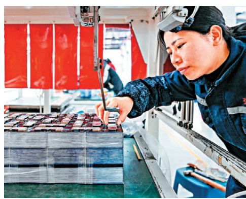
●工人正進行電池組的檢測，電芯餘量不足四成的將進行破碎、分選，從中提煉出碳酸鋰、硫酸鎳等原料。
