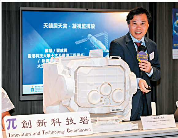
●圖為香港科技大學牽頭研製的溫室氣體探測儀「天韻相機」。
