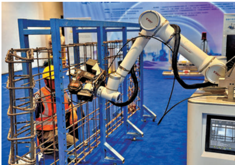
●發展局規定指定金額以上工務工程顧問及工程合約在設計、招標及建造階段採用指定AI技術。圖為機器人在紮鐵。
