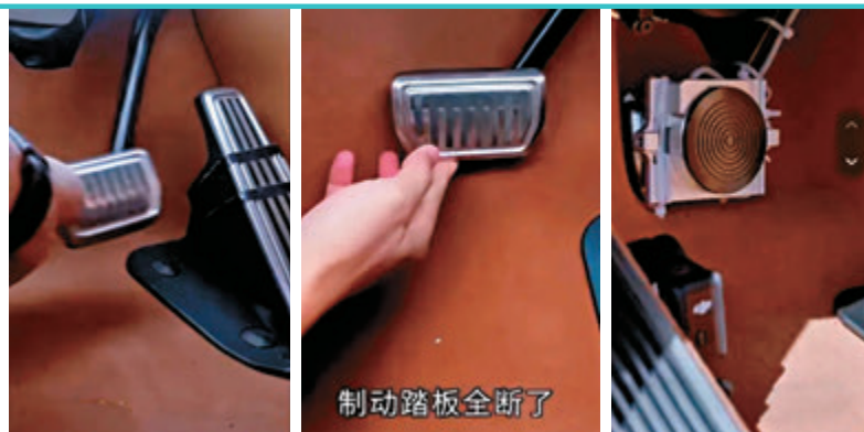
● 8日，內地汽車資訊平台「懂車帝」發布的一則測試視頻顯示，3台全新尊界V800在封閉場地進行100km/h至0的緊急制動測試，剎車踏板支架均發生斷裂。網上圖片
